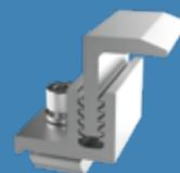
Instale os terminais finais nos módulos das extremidades, utilize todos os parafusos de fixação. Verifique o correto posicionamento do terminal final com as garras de fixação para o correto travamento do módulo ou painel fotovoltaico, sendo que todo módulo na extremidade deverá conter 2 terminais finais.
