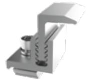
Instale os terminais finais nos módulos das extremidades, utilize todos os parafusos de fixação. Verifique o correto posicionamento do terminal final com as garras de fixação para o correto travamento do módulo ou painel fotovoltaico, sendo que todo módulo na extremidade deverá conter 2 terminais finais.
