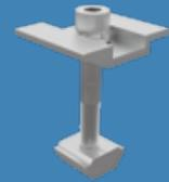
Instale os terminais intermediários entre os módulos, utilize todos os parafusos de fixação. Verifique o correto posicionamento do terminal intermediário com as garras de fixação para o correto travamento, em cada espaço entre dois módulos deverá ter 2 terminais intermediários.
